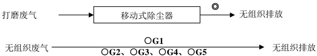
**图 3-2 废气排放走向及监测点位图 ○：废气监测点位**
